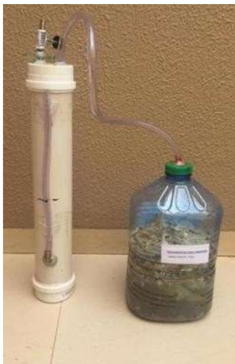
Figura 3. Biodigestor de batelada para escala laboratorial (Autor, 2020).
